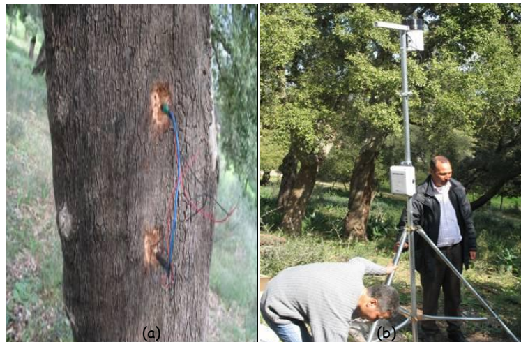
Photo 1 : Dispositif expérimental : mesures de flux de sève par capteur Granier (a) et paramètres climatiques par une station automatique « HOBO » (b) dans une forêt de chêne-liège à Ain Snoussi 2008.
